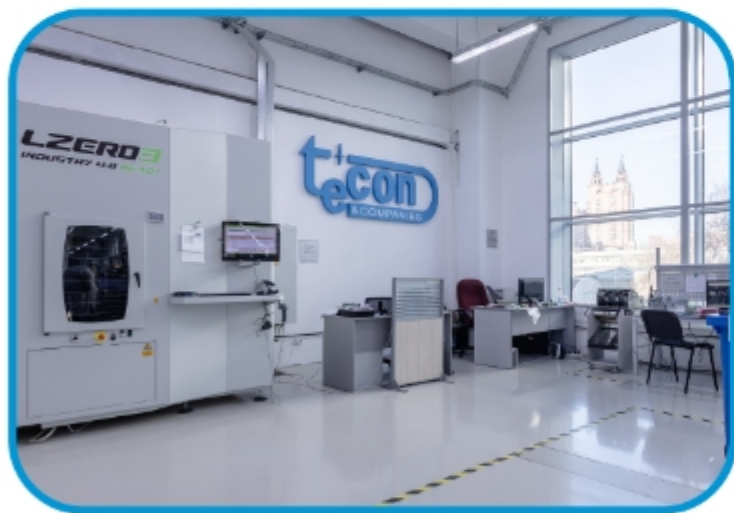
Автоматический склад хранения компонентов
