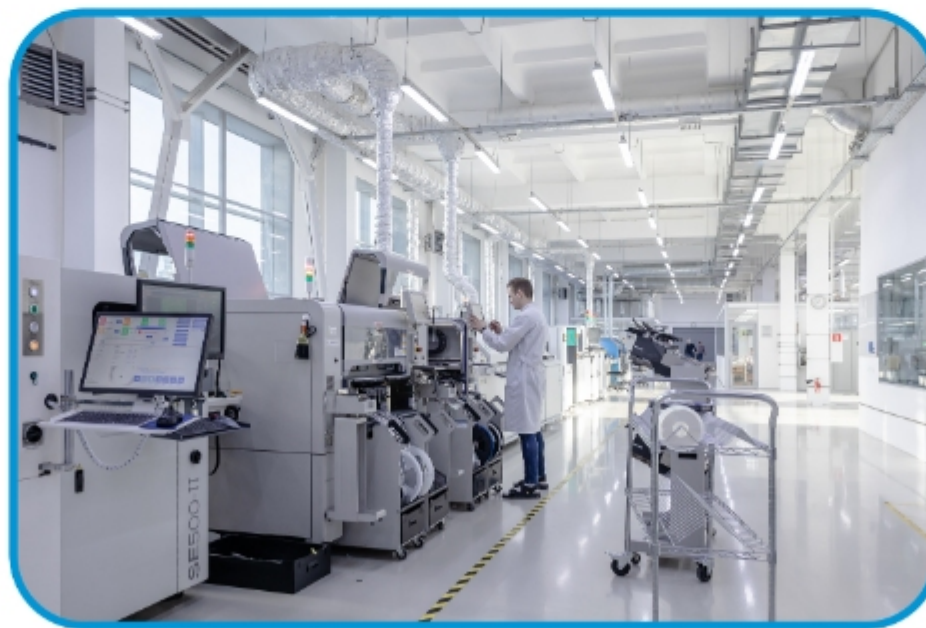
Линия монтажа печатных плат
